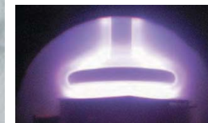
▲プラズマ中でのカーボンナノチューブの生成の様子
