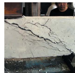
▲鉄筋コンクリート梁の曲げ・せん断試験
