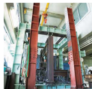
▲1MN級大型構造物試験装置
