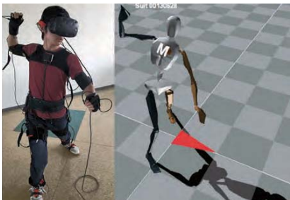
▲HMDと動作計測装置を装着した学習者とアバターの姿で提示された模範動作
