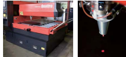
▲レーザーによる銅板の精密切断
