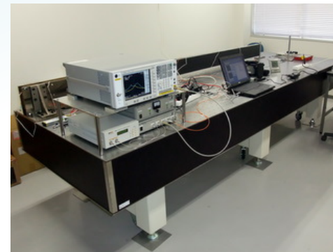
実験用に構築した不均一ひずみ分布発生機構と光ファイバセンシングシステム
